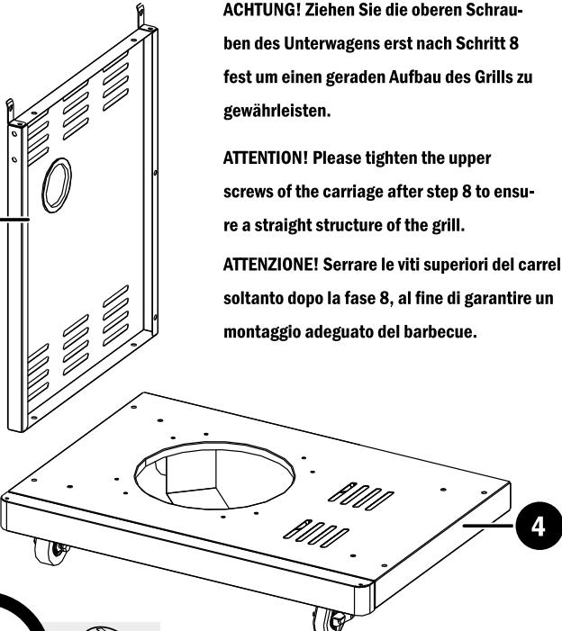
**ACHTUNG!** Ziehen Sie die oberen Schrauben des Unterwagens erst nach Schritt 8 fest um einen geraden Aufbau des Grills zu gewährleisten.
